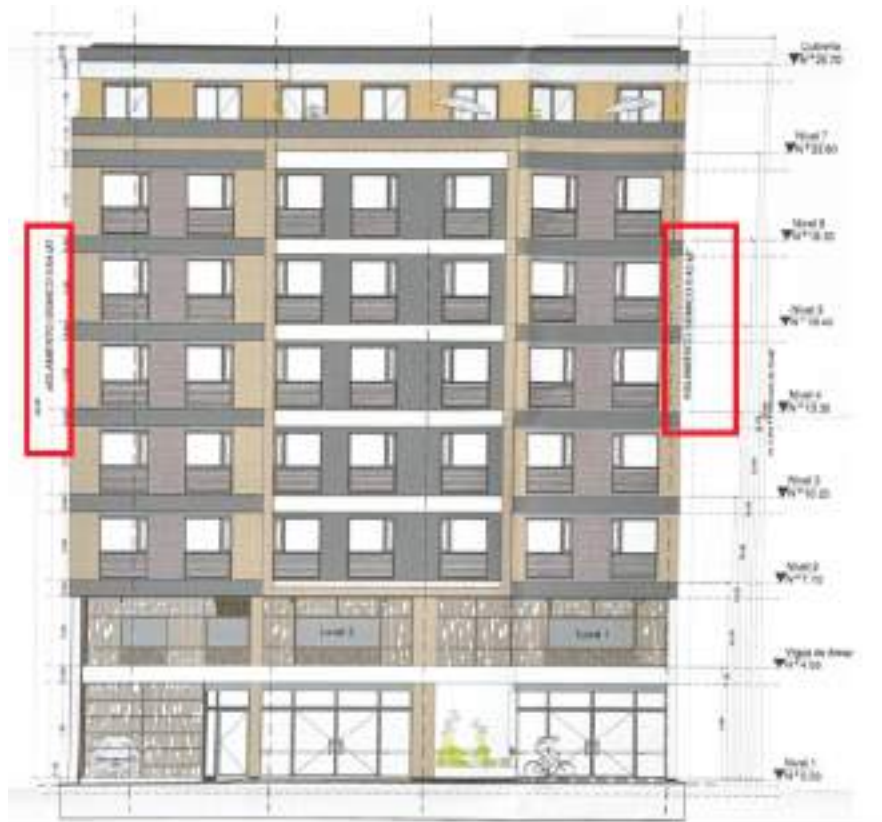
Separación Sísmica Contemplada en los diseño LC 11001-5-25-0349
