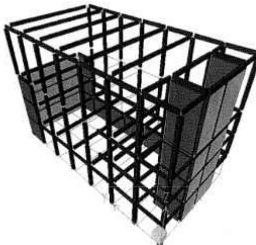
Modelo 3D Estructura de Pabellón MLC 16-3-0660
